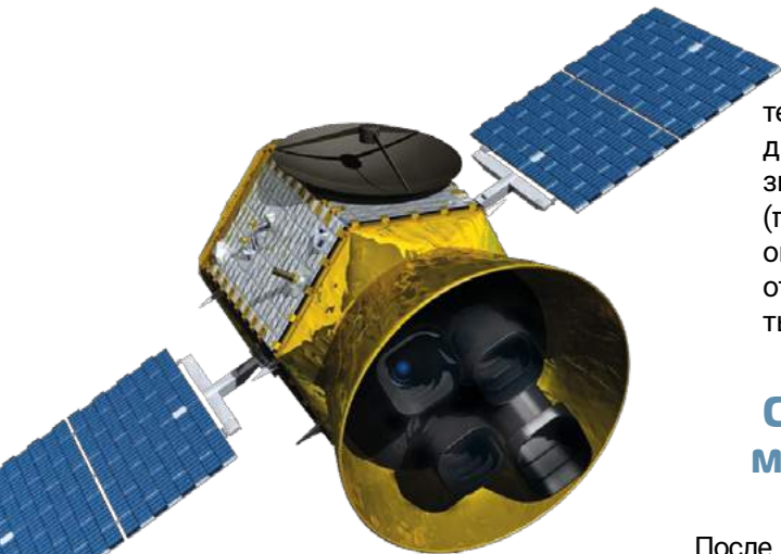
▲ Космический аппарат TESS (Transiting Exoplanet Survey Satellite) в представлении художника. Главная задача этого телескопа с большим полем зрения — поиск экзопланет у ближайших и самых ярких звезд транзитным методом. К настоящему времени он завершил обзор трех секторов северного полушария небесной сферы.
