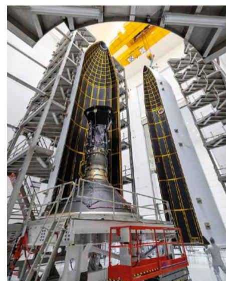
▲ Установка зонда Parker Solar Probe в 19-метровый головной обтекатель производилась в цехах компании Astrotech Space Operations (Титусвилль, Флорида). Позже аппарат был доставлен на стартовый комплекс LC 37 станции ВВС США «Мыс Канаверал».
